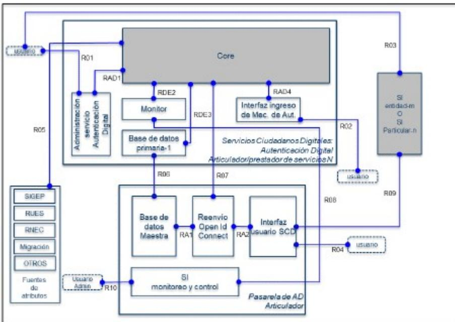
Ilustración 11 - Modelo de despliegue servicio de Autenticación Digital
