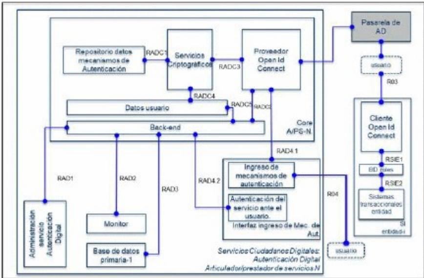
Ilustración 12 - Componente CORE del servicio de Autenticación Digital
