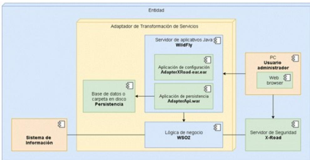
Figura 12 Diagrama de despliegue del Adaptador de integración
